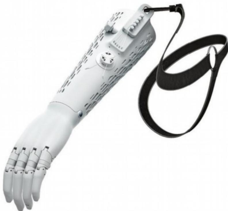
HELPER-肩背驱动义肢 利用3D打印技术进行设计，另一侧背部肌肉拉动背带，从而驱动假肢每一个手指关节。每根手指有两个可活动关节，设有巧妙的连杆结构和扭簧结构。通过高超的结构设计让假肢可以灵活地运用，还给残肢青少年一个自信的笑容。本版图片均由主办方供图
