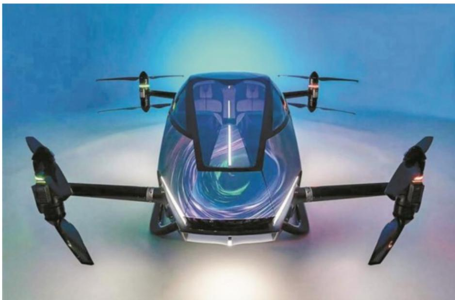
小鹏旅航者X2纯电动载人飞行汽车 旅航者X2是小鹏汇天研发的纯电动载人飞行汽车，采用分布式多旋翼的构型设计，扁平的机身姿态既富有未来感又极大降低了风阻，可容纳两人的座舱采用笼式机身设计，整机高达90%的先进碳纤维复合材料，用户可以准确地感受到X2带来的安全感、舒适性以及顺畅的驾驶体验。
